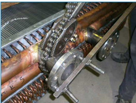
Installation d'une bride à visser
