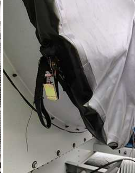
Apriete la correa para asegurar la cubierta
