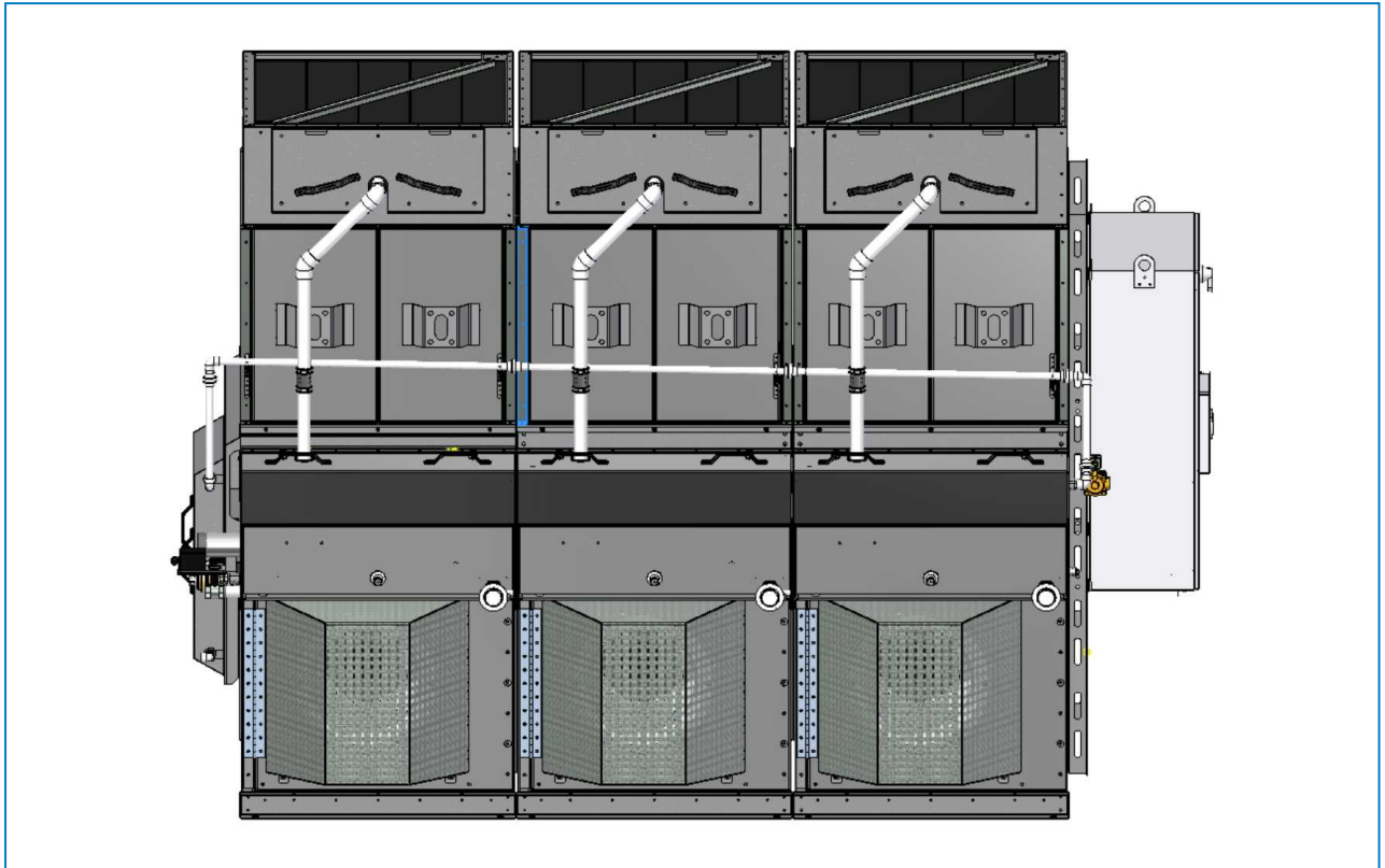
Рисунок 49. Установленный перекрестный трубопровод
